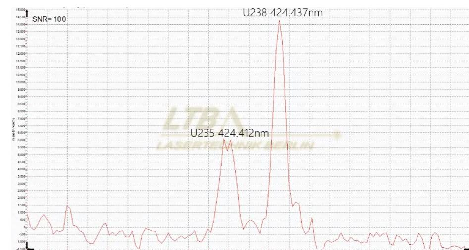
DEMON系列的超高分辨率光谱探测能力(及ns级时间分辨能力)使得铀、钚、锂等元素的同位素频移研究成为可能。如上光谱，U235/238在424.4nm位置的同位素频移为25pm，有效区分这个频移所需要的分辨率为8.3pm；而DEMON在该位置的实用分辨率为5.7pm，可以看到该位置同位素shift被有效区分。利用激光诱导击穿光谱(LIBS)，这些同位素频移可免制样在一秒钟时间内完成精确测量，只需要对样本进行光学介入。
