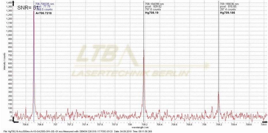
探测器上获得的光谱信号功率密度与光谱分辨率的提升成平方反比关系，因此通常情况下光谱仪获得高分辨率的代价是灵敏度的降低；而DEMON的特殊设计使其在获得业界顶尖的光谱分辨率的同时兼顾卓越的灵敏度；
