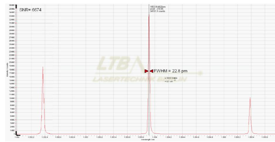
对于光刻和通信技术中使用的半导体激光器的开发、生产控制和质量测试中，DEMON也是一款卓越的测量仪器。与该领域传统的干涉式测量仪器不同，用户可以同时监控激光输出的纵模结构、线宽、纵模光谱能量分布及绝对波长……等信息。如上光谱所示，该光谱为通讯波长1550nm激光的实测光谱。
