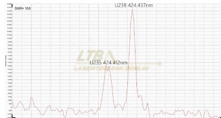
DEMON系列的超高分辨率光谱探测能力(及ns级时间分辨能力)使得铀、钚、锂等元素的同位素频移研究成为可能。如上光谱，U235/238在424.4nm位置的同位素频移为25pm，有效区分这个频移所需要的分辨率为8.3pm；而DEMON在该位置的实用分辨率为5.7pm，可以看到该位置同位素shift被有效区分。利用激光诱导击穿光谱(LIBS)，这些同位素频移可免制样在几秒钟时间内完成精确测量，只需要对样本进行光学介入。
