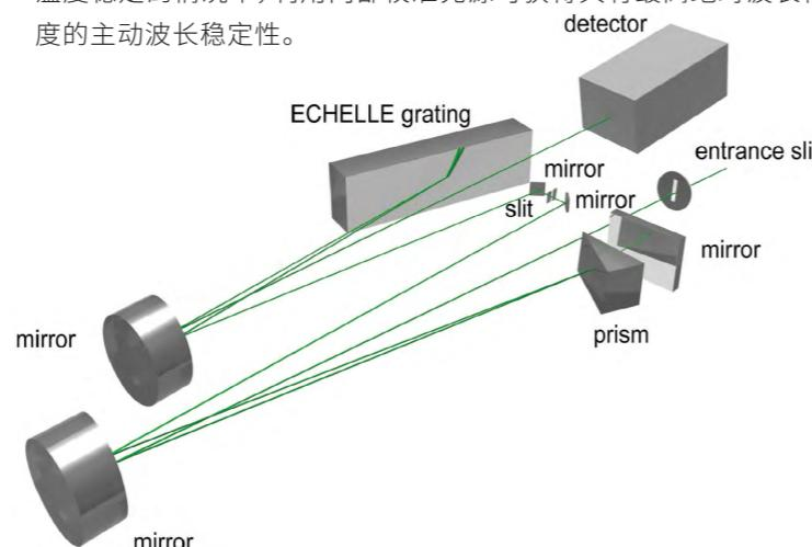
采用宽光谱UV增强镀膜的反射式光学系统结合及CaF<sub>2</sub>棱镜构成色散系统，避免了光学色差的影响，使DEMON可以完美工作在DUV~NIR区域实现超高精度光谱测量；DEMON通过具备SMA标准接口的光纤，或反射式光学元件实现光谱信号高效耦合；并且针对不同的光谱探测区域，DEMON可以灵活配置各种不同配置的CCD,EMCCD,ICCD探测器。
